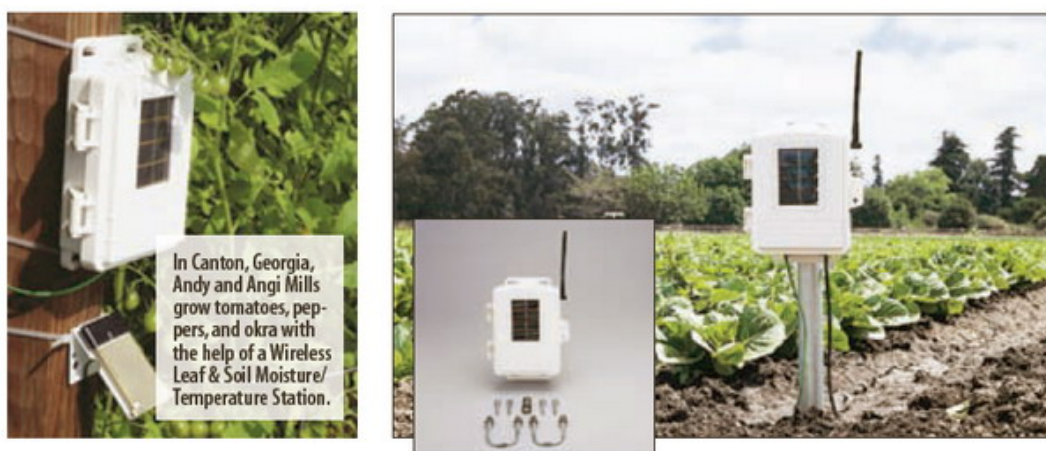
ภาพ 54 เซ็นเซอร์ตรวจวัดอุณหภูมิและความชื้นของดินที่ใช้พลังงานจากแสงอาทิตย์ ส่งข้อมูลไป Server ด้วยสัญญาณวิทยุ
