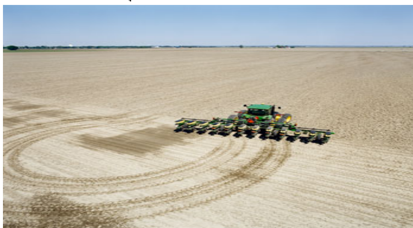
ภาพที่ 52 ระบบรถแทรกเตอร์ขับเคลื่อนด้วยการนำทางจาก GPS ของบริษัท John Deere ประเทศสหรัฐอเมริกา
