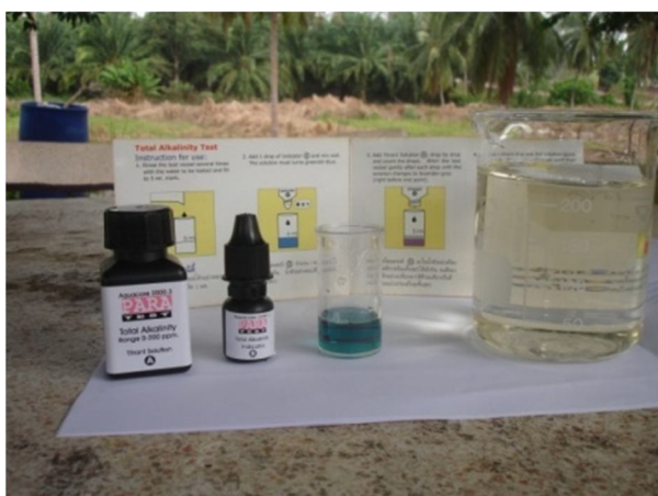
วัด Total Alkalinity ของน้ำในระบบ
